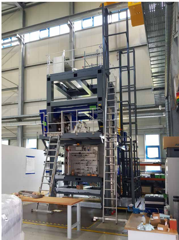
Float Zone Anlage des IKZ bei PVA Tepla in Jena bei der technischen Diskussion
