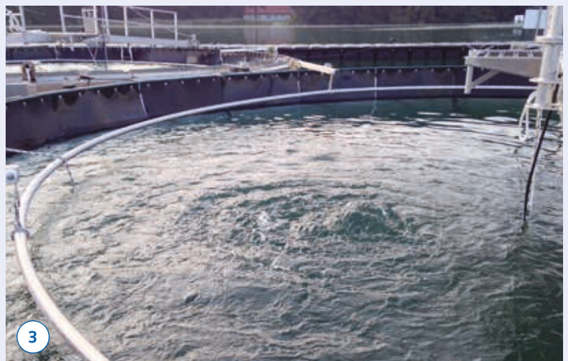
Ziel des Großexperiments war es, einen kurzen, heftigen Sturm zu simulieren, der die Wasserschichtung zerstört. In vier Versuchszylindern durchmischten die IGB-Forscher darum Anfang August 2014 die Wassersäule mit Hilfe von Pumpen bis in eine Tiefe von 14 m.
