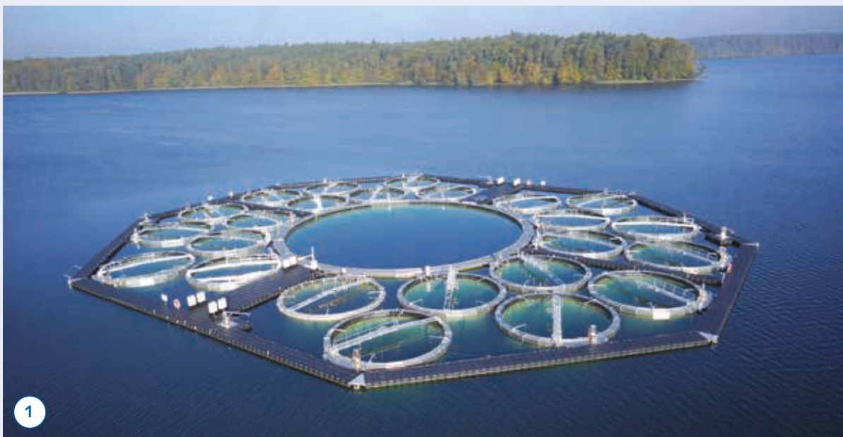
Für ihren Versuch nutzten die Wissenschaftler das im Stechlinsee schwimmende Seelabor. Es besteht aus insgesamt 24 Versuchszylindern von jeweils 9 m Durchmesser und 20 m Tiefe. Die so geschaffenen Seebecken mit einem Volumen von 1.250 m 3 weisen sehr ähnliche Charakteristika wie der See auf.
