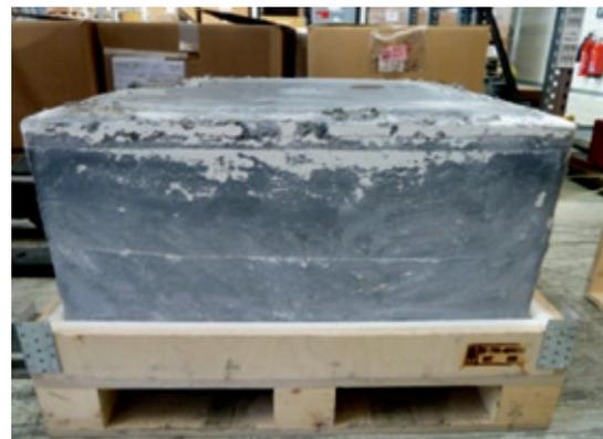
*Fig. 6: A mc-Si ingot (> 600 kg) solidified under the influence of TMF. Abb. 6 Ein unter dem Einfluss von Wandermagnetfeldern erstarrter mc-Si Block (> 600 kg).*
